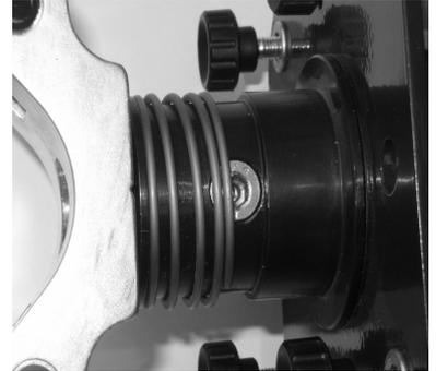
Abb. 3: Feder sichert Schraube
