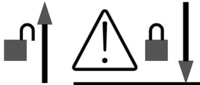
Die vom Projektor abgewandte Seite (Außenseite) der Adapterplatte ist mit Senkbohrungen und diesem Warnhinweis versehen. Beachten Sie die maximale Tragfähigkeit (WLL) der Adapterplatte.
